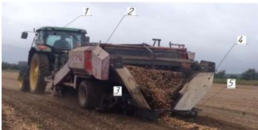
Рис. 5 – Агрегат для збирання цибулі-сіянки: 1 – трактор John Deer; 2 – машина для збирання цибулі-сіянки "Амас D - 2"; 3 – роликовий сепаратор відділення цибулин від ґрунтових домішок; 4 – звужувальний лоток; 5 – утворювач валка.
