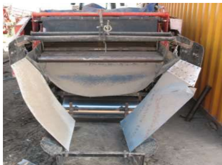
Рис. 2 – Загальний вигляд машини для збирання цибулі-сіянки, оснащеної роликівим сепаратором відділення цибулин від ґрунтових домішок (вигляд ззаду)
