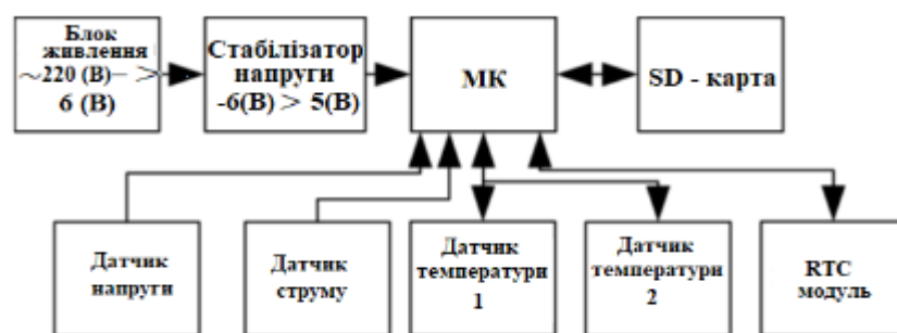
Рис. 1 – Блок-схема системи автоматичної реєстрації параметрів сонячного концентраторного модуля
